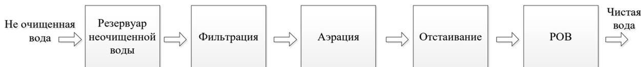
Рис. 2.3.1. Блок-схема станции водоочистки с. Моряковский Затон
